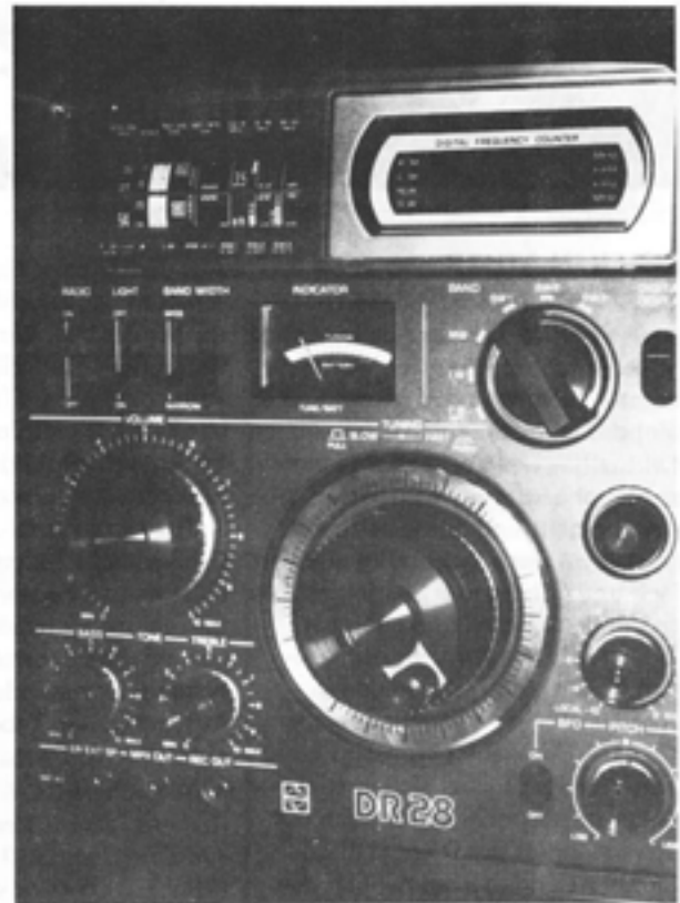
Abstimmung und Anzeige beim DR28. Im Gegensatz zum DR48 ist die Digitalanzeige für alle Bereiche brauchbar.
