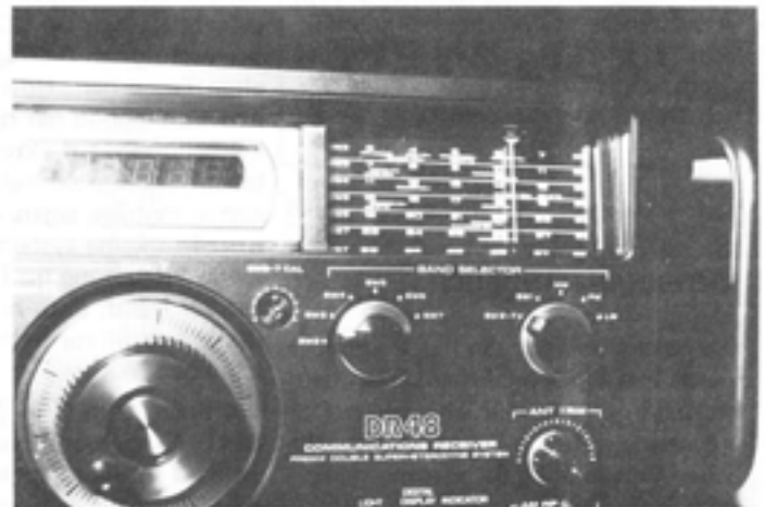
Abstimmung und Anzeige beim DR28. Im Gegensatz zum DR48 ist die Digitalanzeige für alle Bereiche brauchbar.
