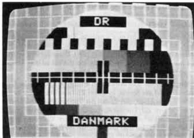
Elektron. Testbild (Generator PM 5544) des dänischen Fernsehens
